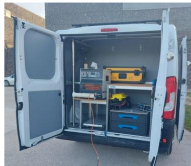
Equipos de inspección mediante cámara de TV
